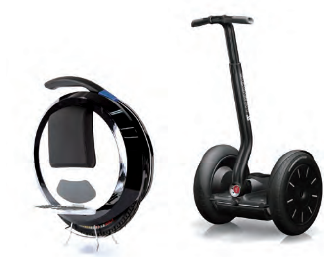
요즘 대세인 전동휠은 하나의 바퀴를 단 외발형(One Wheel)과 2개의 바퀴가 달린 양발형(Two Wheel)으로 나뉜다
